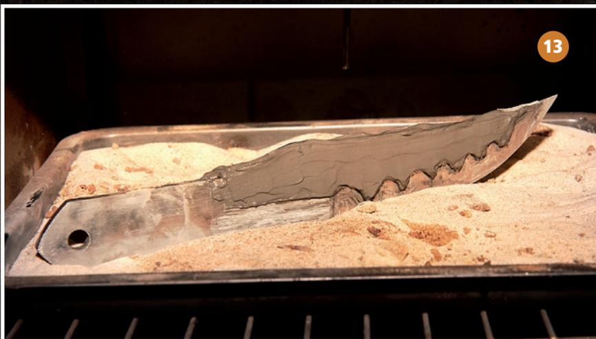
Wo sich Martensitgefüge gebildet hat, steht die Klinge stark unter Spannung. Diese „Verspannungen“, die den Stahl spröde machen, löst man, indem man die Klinge möglichst gleich nach dem Härten mindestens ein Mal bei 200 Grad für eine Stunde anlässt.
