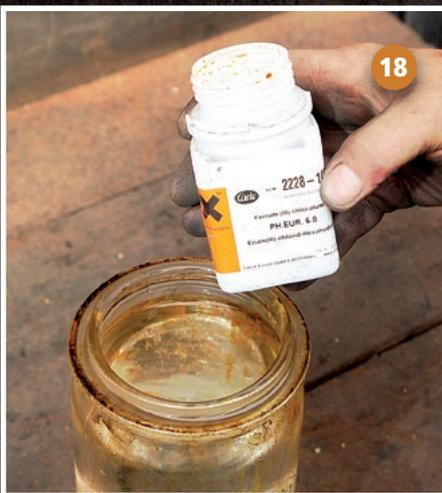
In Japan wird oft tagelang poliert. Eisen(III)-chlorid ist eine einfachere Methode, um die Härtelinie hervor zu holen.
