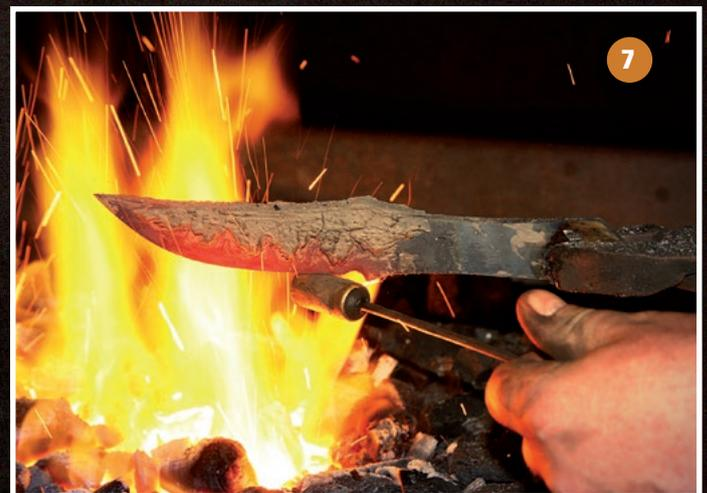
Ist die Paste nach mehreren Tagen getrocknet, wird die Klinge (es muss ein Carbonstahl sein) auf Härtetemperatur gebracht. Die ist erreicht, wenn die Klinge nicht mehr magnetisch ist.
