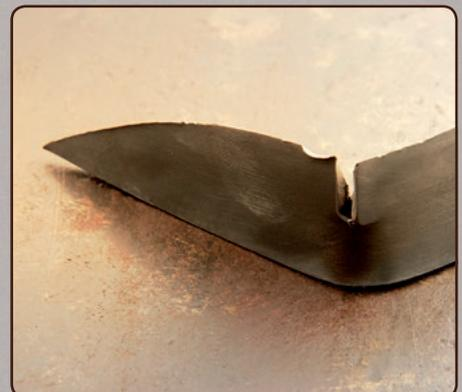
Die Kombination aus Härte und Zähigkeit macht's: Diese selektiv gehärtete Klinge überstand – im Schraubstock eingespannt – wuchtige Schmiedehammerschläge.
