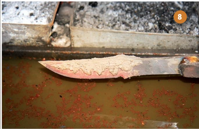
Die Klinge ist komplett durcherhitzt und wird gleich eingetaucht. Die Härtung im Wasser ist schroffer als im vorgewärmten Ölbad, erzeugt jedoch unter Umständen eine schönere und deutlichere Härtelinie.
