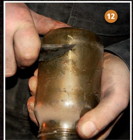
Ein Schnitt, noch ein Schnitt – die Feuertaufe ist bestanden: Der Schneidenbereich hat die erforderliche Härte.
