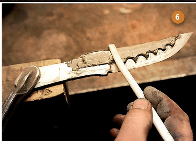
Mit einem Teflonspachtel wird die traditionelle Härtepaste ein paar Millimeter dick aufgetragen. Wichtig ist, dass der Schneidenbereich großzügig frei bleibt. Weite Wellen machen den Hamon lebhafter.
