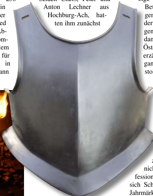
(Noch) beschussfreie Harnischbrust aus einem Stück – im Feuer geschmiedet und bis zu neun Millimeter stark.
