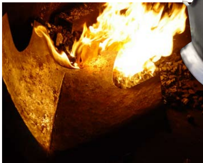
(Noch) beschussfreie Harnischbrust aus einem Stück – im Feuer geschmiedet und bis zu neun Millimeter stark.
