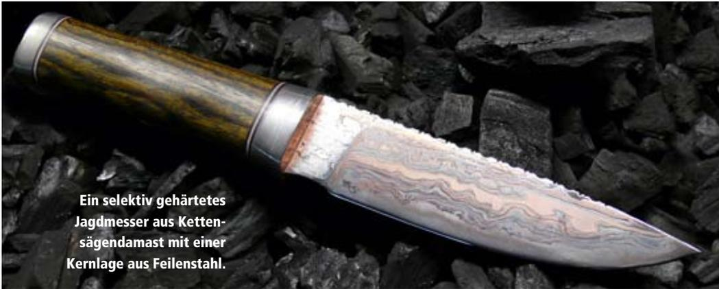
Ein selektiv gehärtetes Jagdmesser aus Ketten-sägendamast mit einer Kernlage aus Feilenstahl.
