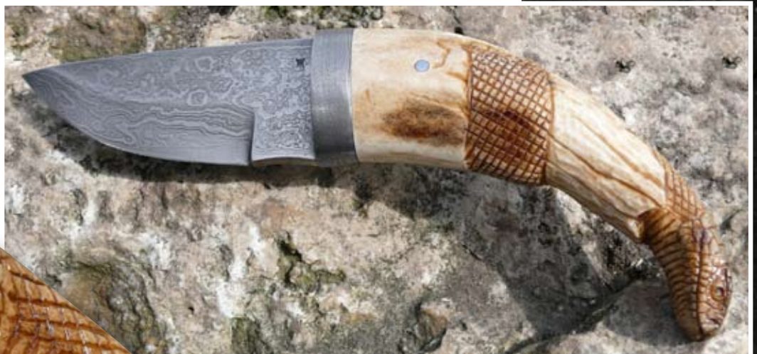
Das Messer besitzt eine 128000-lagige Klinge aus Kettensägen- und Silberstahl, Feile und Eisen. Der Hirschhorn-Griff mündet in einen Schlangenkopf.
