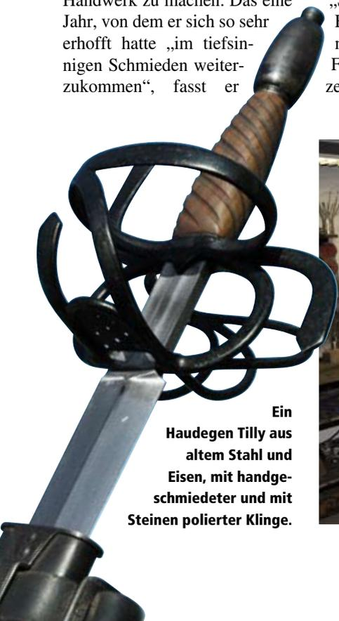
Ein Haudegen Tilly aus altem Stahl und Eisen, mit handgeschmiedeter und mit Steinen polierter Klinge.
