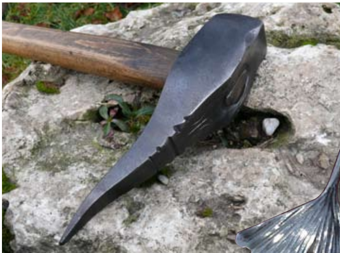
Ein geschmiedeter Streithammer aus C50-Stahl mit einem Stiel aus heimischer Esche. Tobias Haselmayr übernimmt auch die Leder- und Holzbearbeitung.
